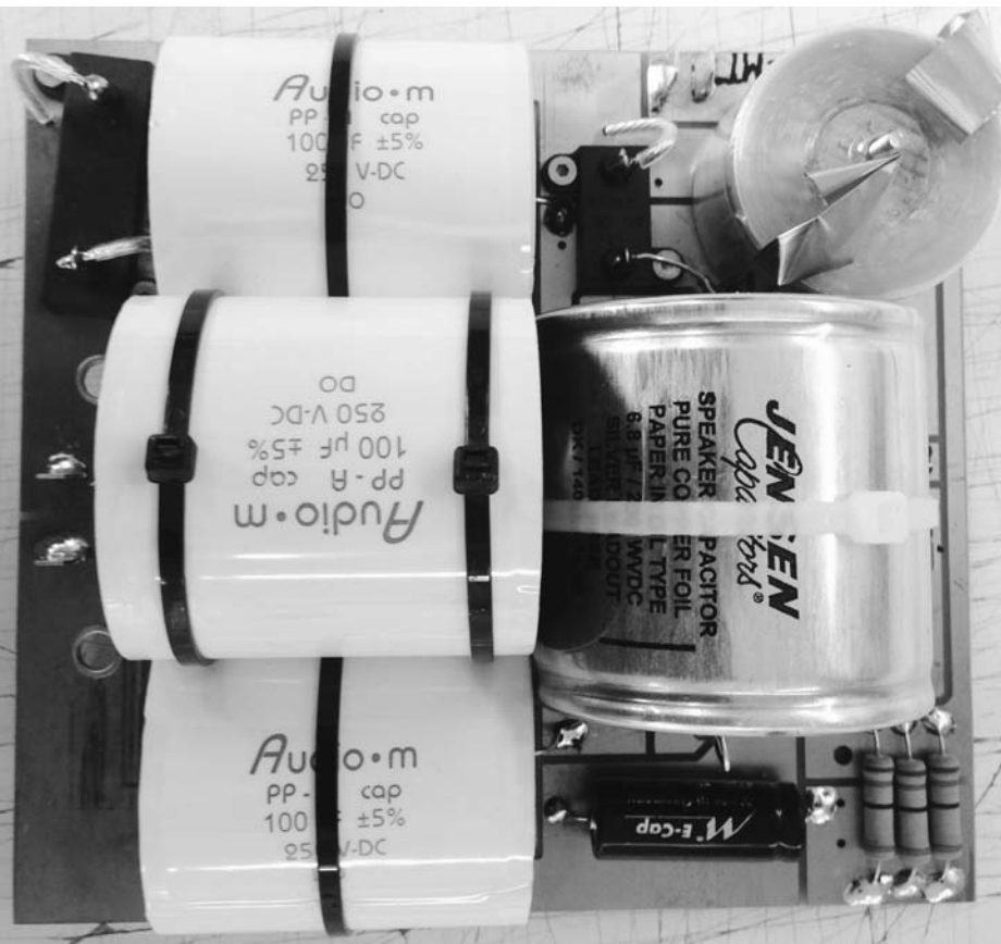
Edelste Bauteile auf der Frequenzweiche, etwa ein Jensen Ölpapier-Kondensator.
